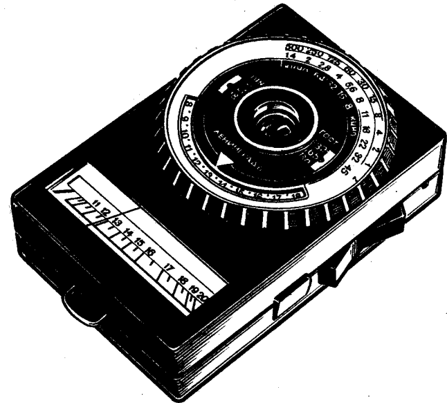
Рис. 22. Фотоэлектрический экспонометр «Ленинград-6»
