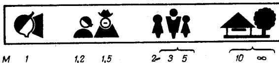
Рис. 1. Шкалы расстояний и масштабные символы для фокусировки объектива шкальных фотоаппаратов
